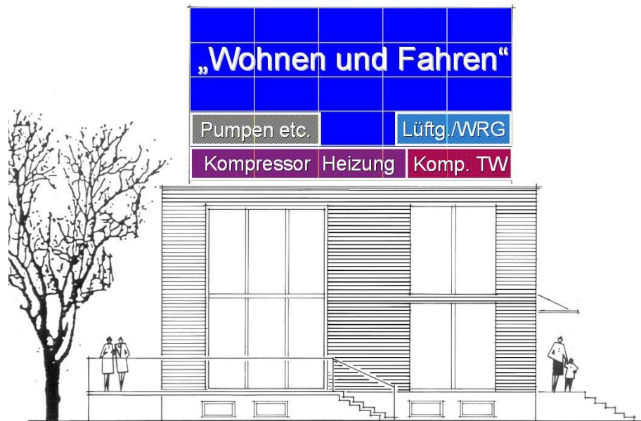
Bild 13: Aufteilung des Solarstromertrags von 7500 kWh/a
